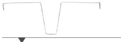
Soporte de acero galvanizado que se adapta a la puerta para evitar que la correspondencia se caiga al abrir el buzón.
